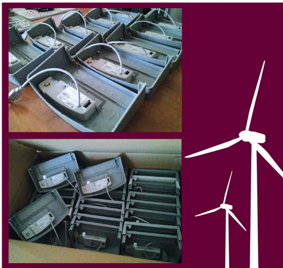
Rysunek 77. Modemy komunikacyjne podłączane do licznika energii za pośrednictwem portu USB
